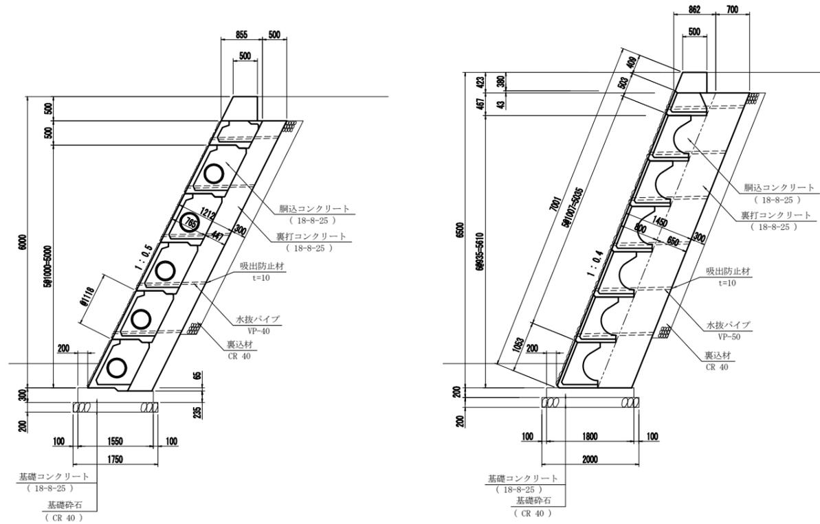
※ 断面はサンプルのため安定計算により控え厚の算出が必要
