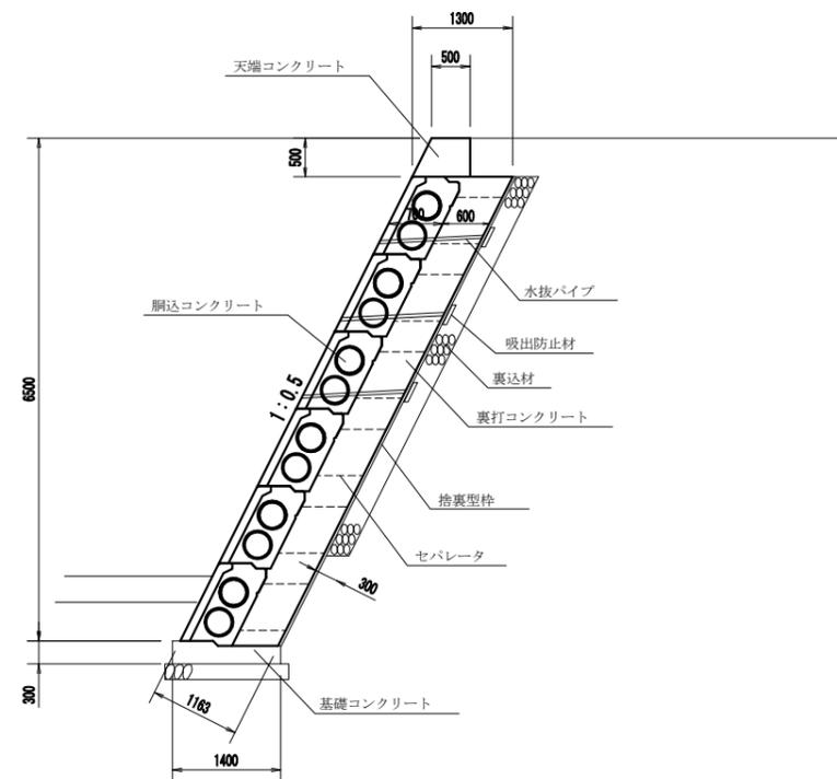
※ 断面はサンプルのため安定計算により控え厚の算出が必要
