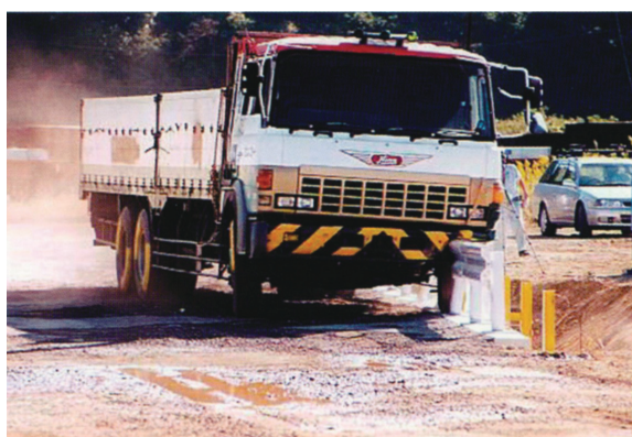
トラック衝突時（直接基礎上）
