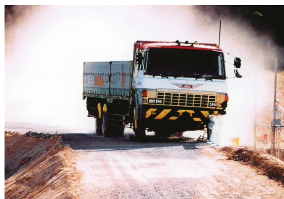
トラック衝突時（補強土壁上）
