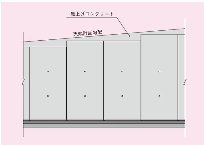
嵩上げコンクリートを現場にて打ち継ぎする場合、仕上り高さより上位の規格品(H寸法の大きい)の頭部を仕切った製品にて対応致します。
