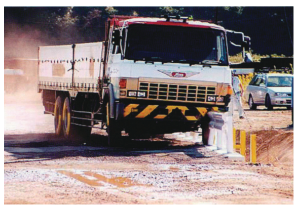
トラック衝突時 (直接基礎上)
