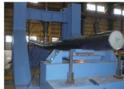
支柱部材の曲げ耐力確認実験
